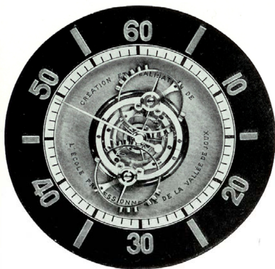
Echappement tourbillon à double régulateurs.
